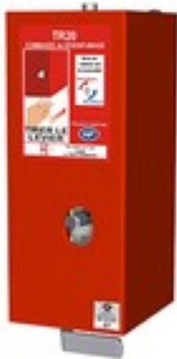
DAC à relâchement de câble d'acier avec ou sans module Treuil à câble pour la commande d'ouverture et fermeture d'un DENFC mécanique. Manœuvre manuelle pour le confort/aération avec la manivelle. Possibilité d'équiper le treuil avec 2 modules de télécommande. (pneu. et élect.) Capot métallique de couleur rouge, beige ou autre sur demande.
