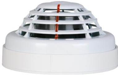
Les détecteurs adressables de la gamme CAP sont équipés d'un isolateur de court-circuit (ICC) autorisant leur installation sur les ECS en ligne rebouclée de 128 points de détection.
